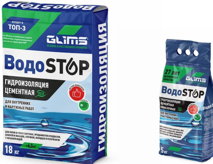
Гидроизоляция GLIMS® ВодоСtop цементная обмазочная жесткая для создания бесшовного гидроизоляционного барьера на вертикальных и горизонтальных основаниях, не подверженных деформации: фундаменты, подвалы, фасады, цоколи, террасы, балконы, резервуары (в т.ч. с питьевой водой), бассейны, колодцы, а также в условиях повышенной влажности: общественные бани, автомойки, балконы, террасы, кухни, ванные комнаты и прочее.
